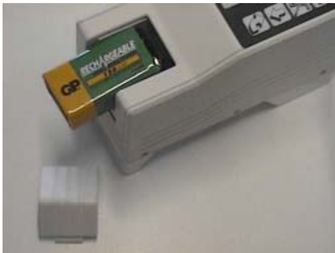
Figura 7. Compartimento da bateria aberto.
