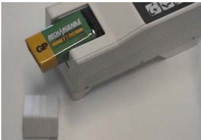
Figure 7. Logement de l'accumulateur ouvert.
