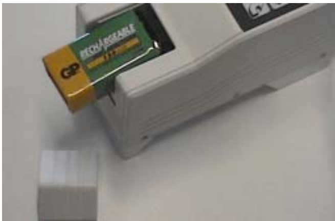
Figura 7. Vano dell'accumulatore aperto.
